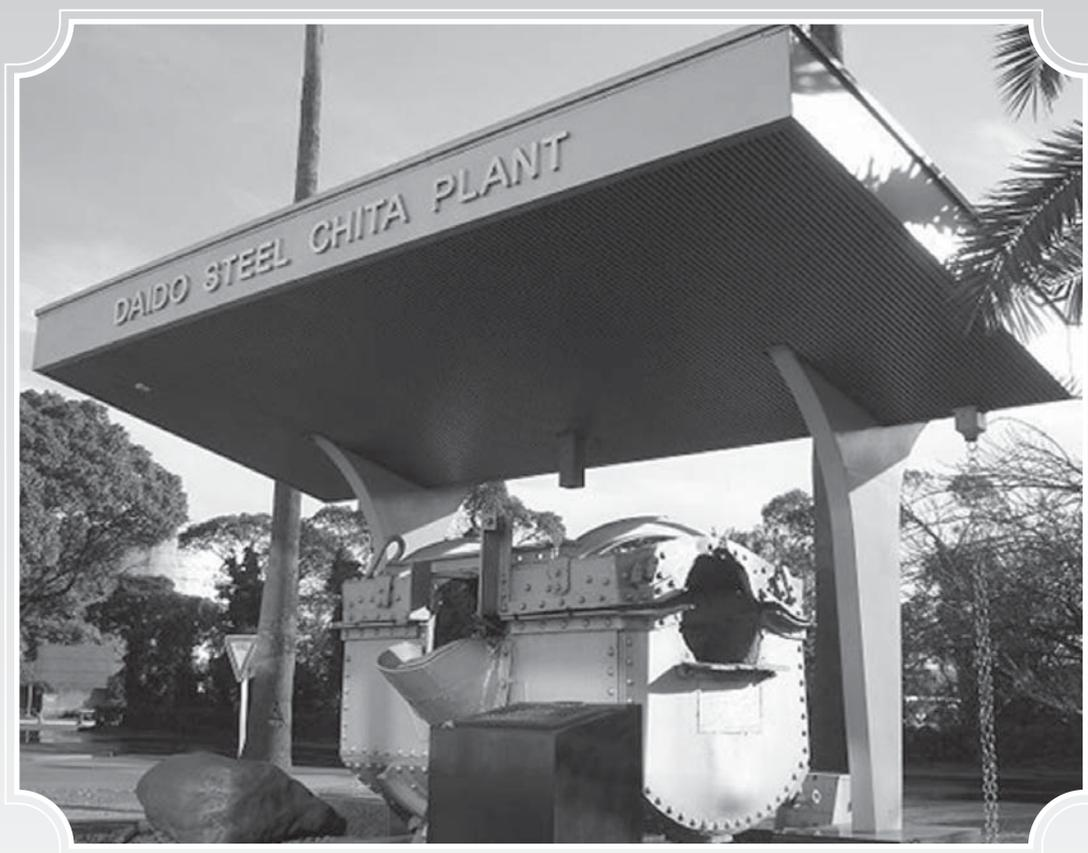
1916年「1.5tエルー式アーク炉 日本最古の工業生産用アーク炉」
